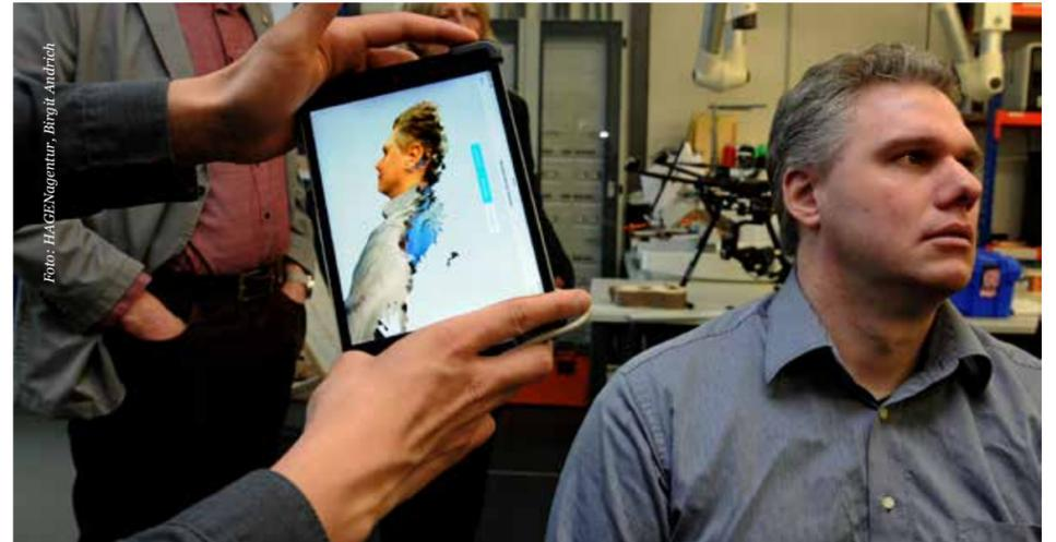
Mit wenigen Zusatzmodulen wird ein Tablet-PC zum 3D-Scanner
